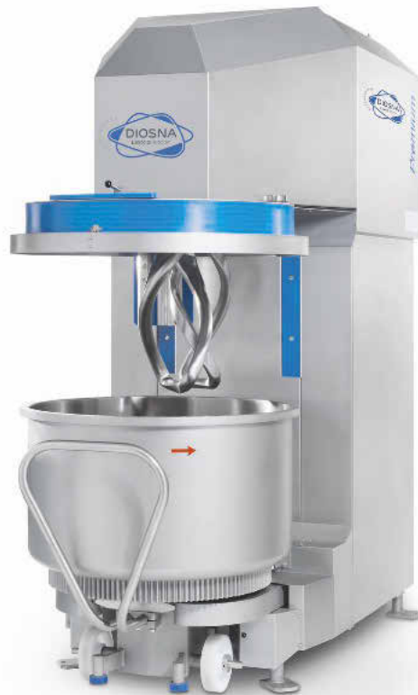
Beim Wendelknetter wird der Teig zwischen den beiden Werkzeugen gestaucht und gedehnt und beim Andruck gegen die Bottichwand noch einmal gewirkt. Dadurch entsteht eine weitere Dimension der Teigknetung.
